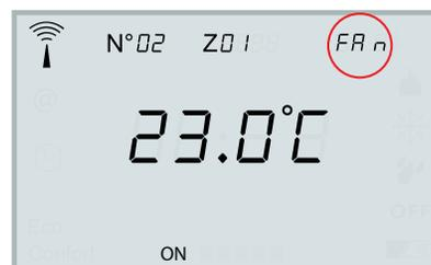
**INFORMATION :** Si vous arrêtez le chauffage en Hiver, lorsque la température dans une pièce descend en-dessous de 10°C, l'appareil gainable se remettra en service automatiquement jusqu'à 10°C ( Température Hors Gel 10°C )
