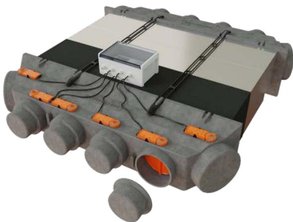
Découpez les piquages en fonction des diamètres de gaines souhaités puis raccordez les gaines nécessaires pour le soufflage et la reprise.
